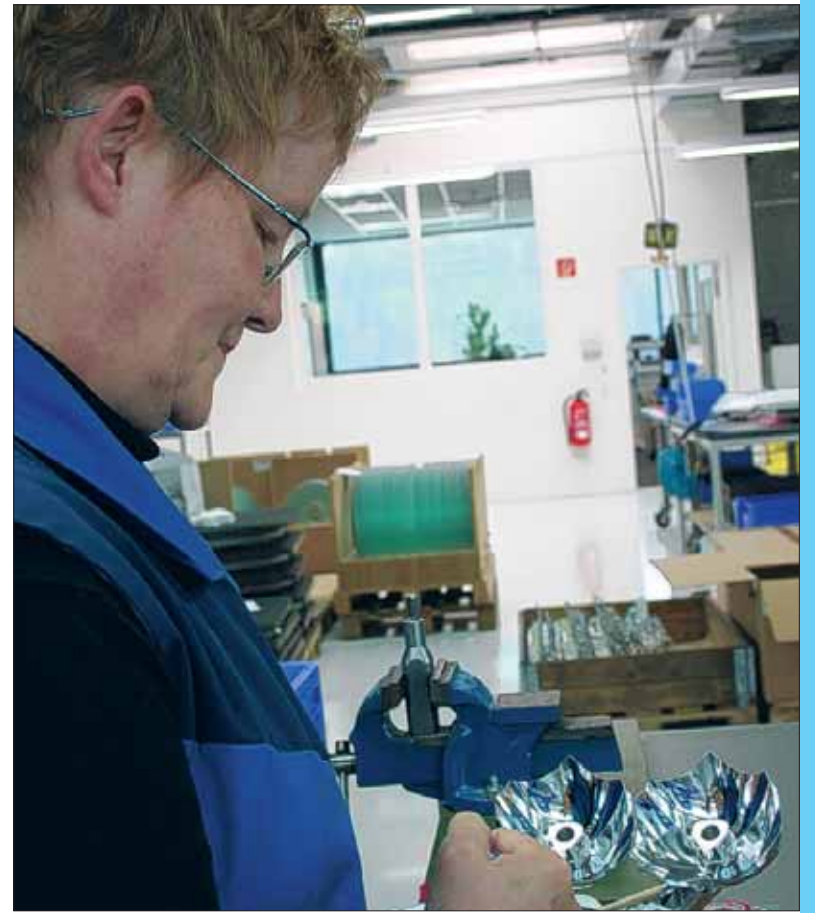
Bei der Montage der Untersuchungs- und OP-Leuchten ist Fingerfertigkeit gefragt, wie hier beim Einbau der Reflektoren für die Sim.LED OP-Leuchte. FOTOS: B. FILLINGER
