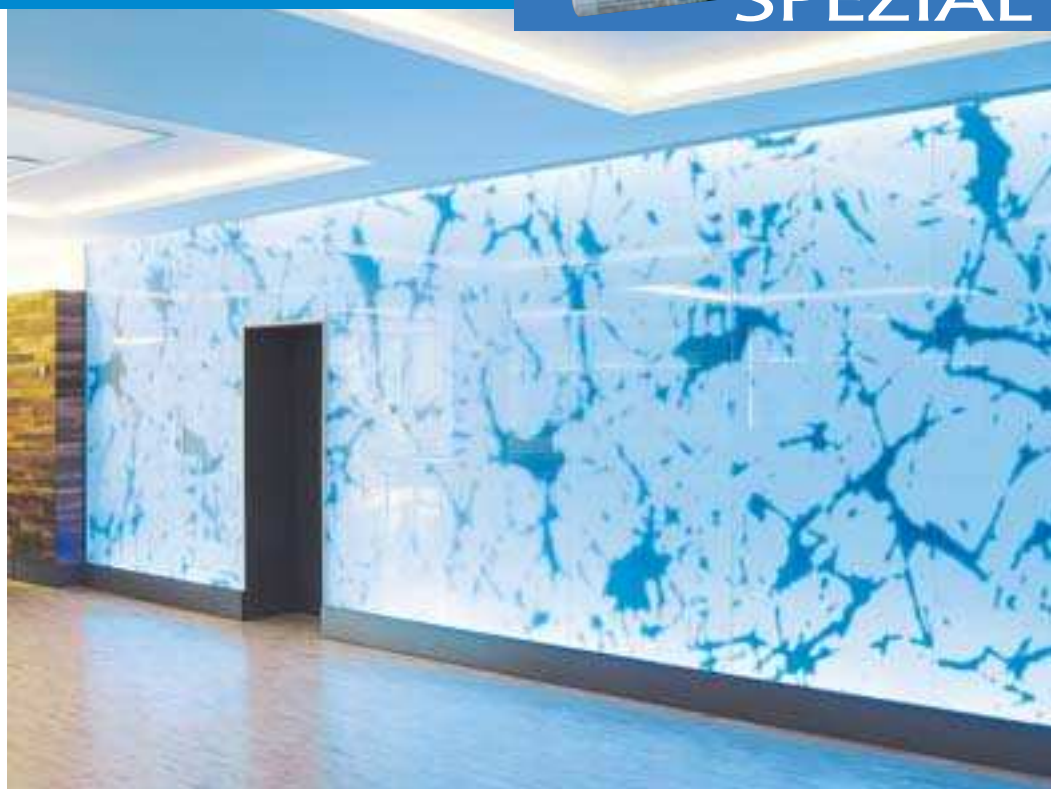
Die Farbigkeit der Lichtwände in der Werkskantine (links) und im Schulungsraum (rechts) kann im Rahmen des RGB-Spektrums verändert werden. Dadurch sind gezielte Raumatmosphären möglich.
